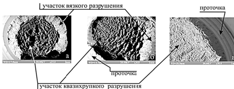
Рис. 4. Изломы сплава ВТ 8, полученные при растяжении:
